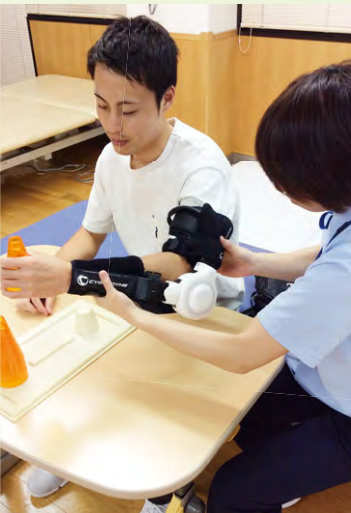
HAL®単関節タイプを用いた練習 上腕二頭筋、上腕三頭筋の収縮を補助し、スムーズな肘の屈伸運動が可能になります。
